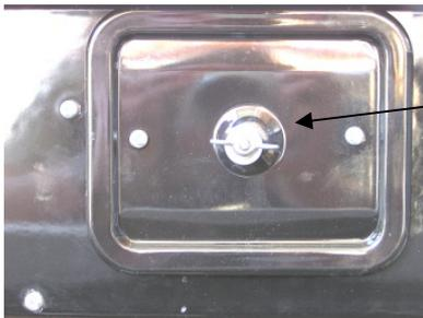
**12** Hinter der Putztürblende befindet sich der Putzdeckel (Bild 7, Position 12). Dieser ist mit einer Flügelmutter an der Herdfront befestigt und muss zum Reinigen der Heizzüge abgenommen werden. Vor dem Wiederanschrauben ist die Dichtschnur am Putzdeckel auf Dichtheit zu kontrollieren und bei Bedarf auszuwechseln.
