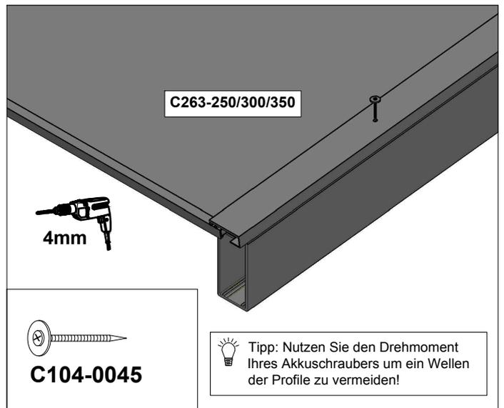
Die Doppelstegplatten und Aluminiumprofile mit den Schrauben (C104-0045) auf den mit 4mm vorgebohrten Sparren montieren. Die erste Schraube wird gemeinsam mit dem Abschlußwinkel verschraubt.
